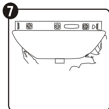
Acople el lavamanos sobre las grapas de fijación y usando un nivel verifique la correcta instalación de este. **NOTA:** Los modelos de lavamanos de colgar tienen perforaciones adicionales en la pieza cerámica para mejorar la sujeción a la pared terminada. Revise su modelo de lavamanos para continuar el proceso de instalación
