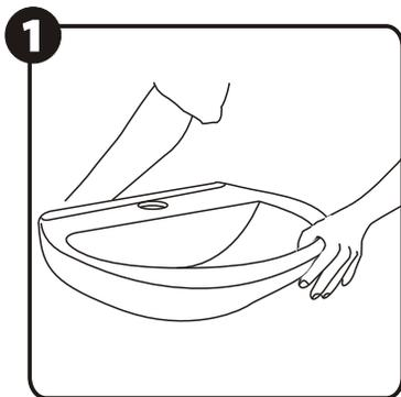
Revise las condiciones de la superficie de instalación. Verifique que el piso y la pared se encuentre perpendiculares entre si y en óptimas condiciones de instalación. Ubique el lavamanos en posición de instalación
