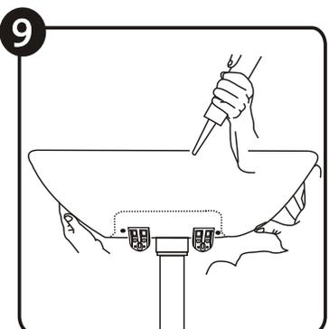
Aplique un cordón de silicona por la parte posterior del lavamanos antes de ponerlo sobre las grapas. Verifique que la silicona (**NO INCLUIDA**) se adhiera correctamente sobre la pared terminada. Ubique el lavamanos en posición de uso, apriete los tornillos de anclaje de grapas fuertemente contra la pared terminada, y apriete los tornillos de fijación a la pared terminada. Revise que haya quedado bien nivelado el lavamanos y nuevamente verifique con un nivel tal como lo hizo en el paso 7.
