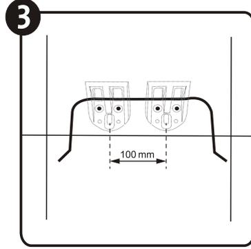
Ubique las grapas de sujeción a una distancia entre ejes de de **100 mm. (3 7/8")** y marque los puntos donde se debe perforar la pared.
