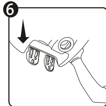
Ubique el lavamanos en posición de instalación, verifique que las grapas de sujeción acoplen adecuadamente en la parte de atrás
