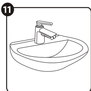
Termine las conexiones y aplique un cordón de silicona por el perímetro del lavamanos para mejor fijación a la pared terminada y evitar oscilaciones, movimientos o rotaciones indeseadas en el momento de uso.
