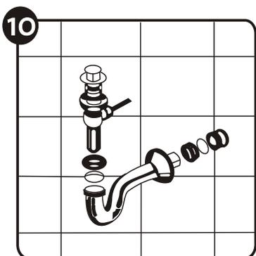
Conecte la línea de desagüe y apriétela firmemente (Verifique si requiere mas partes para lograr la distancia correcta con la pared). Revise las instrucciones del fabricante de la grifería y sus partes.
