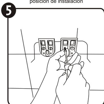
Instale las grapas de sujeción y asegure fuertemente los tornillos contra la pared.
