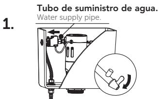
Cierre la válvula de suministro de agua, luego retire la tubería de suministro de agua.
