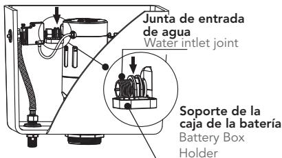
1. Instale el soporte de la caja de la batería en la junta de entrada de agua.
