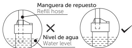
Inserte el tubo de recarga en la tubería de rebosé. Asegúrese de que la manguera de recarga se encuentre por encima del nivel del agua.
