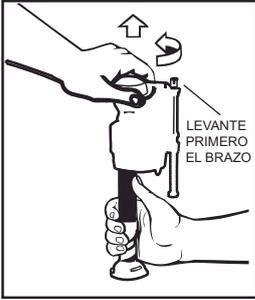
**IMPORTANTE:** Elimine siempre la arena y el óxido que pueda haber en el sistema. Compruebe que el paso de agua está cerrado. Retire la parte superior de la válvula para ello, levante el brazo y hágalo girar con la parte superior 1/8 de vuelta de derecha a izquierda, haciendo una leve presión sobre la tapa.
