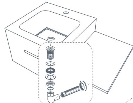
**8.** Termine de armar y conectar los abastos y el desagüe según las instrucciones del fabricante. No aplicar demasiada fuerza sobre el producto, puede romperlo o causar fisuras.
