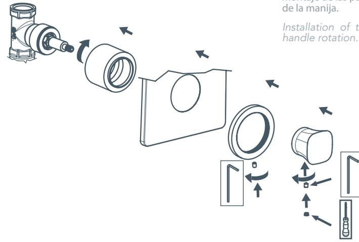
Montaje de las partes externas para seguir la rotación de la manija.
